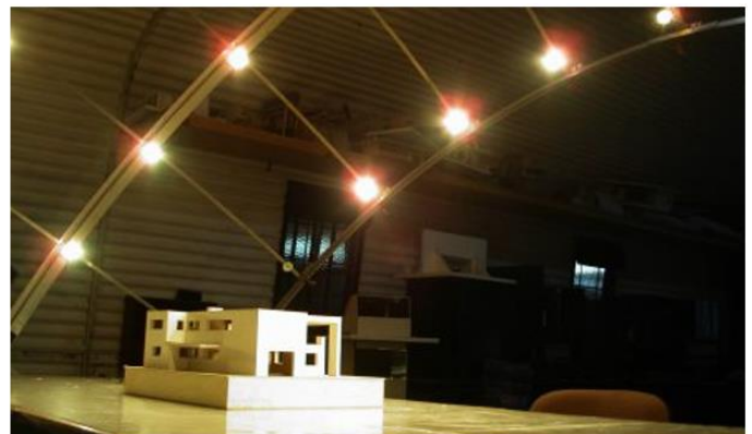
Fig. 1. Análisis experimental de sombras y nivel de luminosidad en edificios a escala. (Fuente: extraído de https://lambda.fau.unlp.edu.ar/equipos , último acceso: 09/03/2023)
