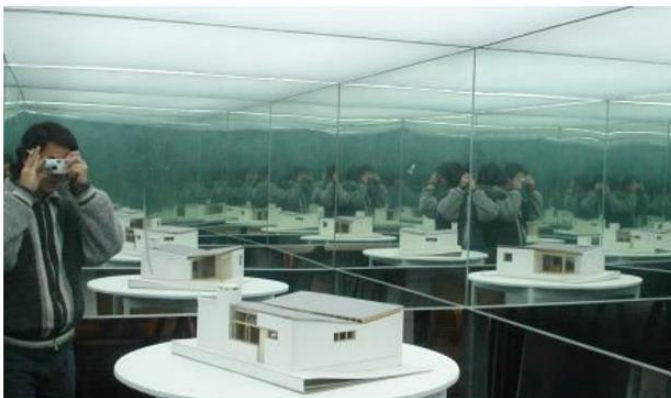
Fig. 1. Análisis experimental de sombras y nivel de luminosidad en edificios a escala. (Fuente: extraído de https://lambda.fau.unlp.edu.ar/equipos , último acceso: 09/03/2023)
