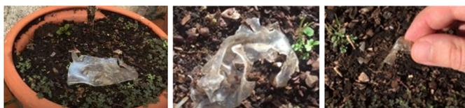
Fig. 4. Izquierda a derecha: plástico antes de someterse a la degradación, tras 30 días y tras 45 días
