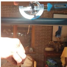
Fig. 3. Probeta siendo sometida a un ensayo de Izod
