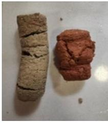
Fig. 9. Probetas 1 y 2 tras el ensayo de compresión
