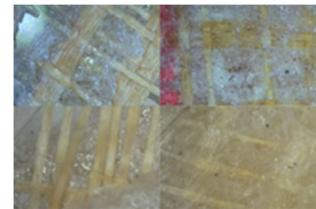
Fig. 4. Fibras de vidrio en el material
