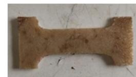
Fig. 2. Probeta obtenida finalmente
