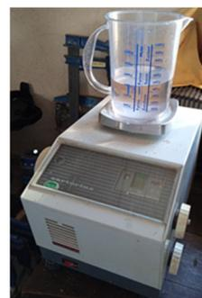
Fig. 9. Balanza analógica con jarra de agua para las mediciones de la densidad.
