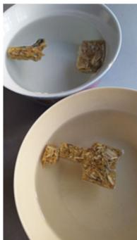
Fig. 5. Ensayo de absorción de agua
