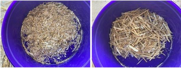
Fig. 3. Tamaño de paja empleado en la probeta 1 (izquierda) y en la probeta 2 (derecha)
