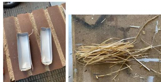
Fig. 2. Moldes empleados en la fabricación del material (izquierda) y tamaño inicial de la paja de trigo utilizada (derecha)
