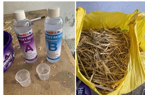
Fig. 1. Resina epoxi y paja de trigo utilizadas para la fabricación del material
