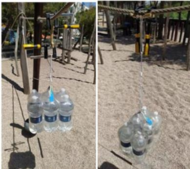
Fig. 4. Ensayos de tracción (izquierda) y de flexibilidad (derecha)
