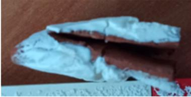
Fig. 4. Resultado del ensayo de compresión
