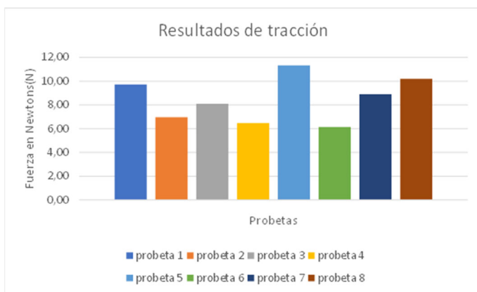
Fig 2. Resultados ensayos de tracción
