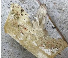
Fig. 2. Probeta sometida al ensayo de resistencia a impacto
