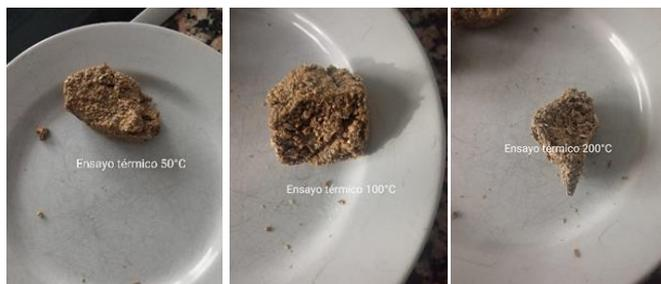
Fig. 2. Imagen de la masilla tras el ensayo térmico a 50, 100 y 120 °C (izquierda a derecha)
