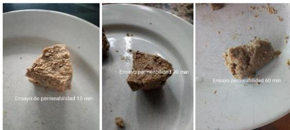
Fig. 1. Imagen de la masilla tras el ensayo de permeabilidad a 15, 30 y 60 minutos (izquierda a derecha)
