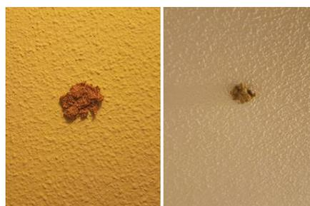
Figura 3. Masilla en el ensayo de adherencia superficie rugosa, perpendicular y paralela al suelo (izquierda y derecha) tras 24h
