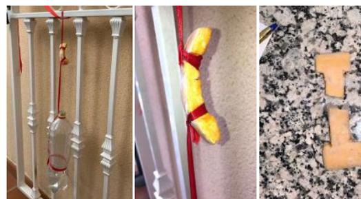
Fig. 4. Proceso del ensayo de tracción
