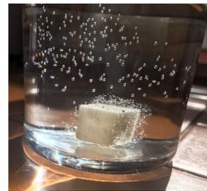
Fig.11. Ensayo por más de 7 horas sumergida en agua
