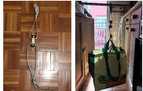
Fig.5. Sistema de mordazas de la probeta y ensayo de tracción
