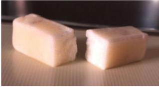
Fig.13. Probeta partida por el ensayo de flexión
