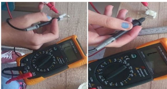
Fig. 9. Ensayo de conductividad eléctrica con probeta de poliuretano con aceite de algas y maicena (izquierda) y con sólo aceite de algas (derecha)
