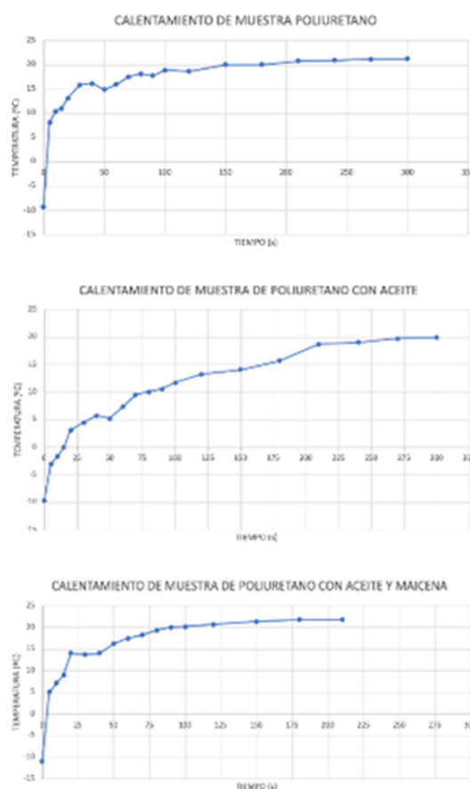
Fig. 8. Resultados del ensayo de calentamiento de la probeta de poliuretano (P.P.), de la probeta de poliuretano con aceite de algas (P.P.A.A.) y de la probeta de poliuretano con aceite y maicena (P.P.A.A.M.)
