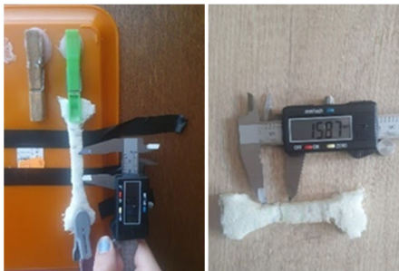
Fig. 12. Ensayo de tracción de probeta de poliuretano con aceite de algas y maicena con fuerza 2940 N (izquierda). Ensayo de tracción fin del ensayo de tracción medición de distancia entre marcas de probeta de poliuretano con aceite de algas y maicena (derecha).
