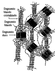
Fig. 4. Microestructura del poliuretano
