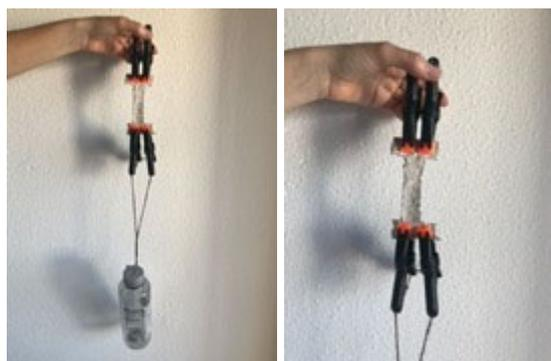
Fig. 7. Ensayo de tracción del material
