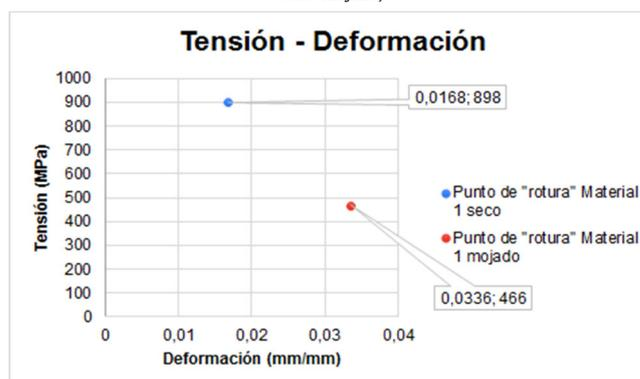
Fig. 10. Gráfica Tensión-Deformación del ensayo de tracción del material 2 (Comparación seco-mojado)
