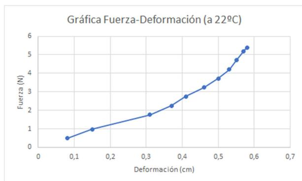
Fig. 8. Deformación en función de la fuerza, ensayo realizado a 22 °C
