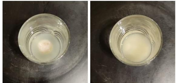
Fig. 6. Muestra recién introducida en el zumo de limón (izquierda). Al cabo de unas horas en el zumo (derecha)
