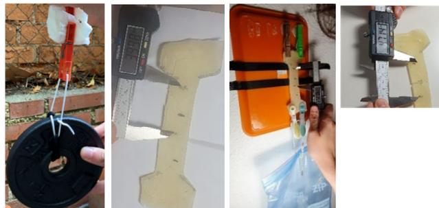
Fig. 13. Desarrollo del ensayo de tracción: aplicación de los pesos, medida de la longitud inicial de probeta ( $L_0$ ), medida de la longitud instantánea durante el ensayo y medida de la longitud final de probeta (L)
