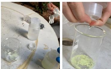
Fig. 7. Elementos del ensayo de tinción (izquierda), muestra a ser rociada con sosa (derecha)
