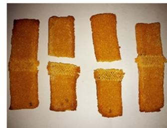
Fig.12. Probetas tras el ensayo de compresión
