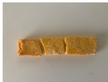
Fig. 21. Probeta rota tras 7 ciclos
