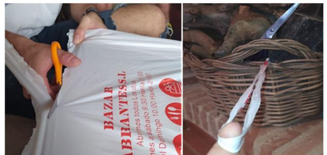
Fig. 1. Proceso de fabricación de las probetas: corte de las bolsas y fijación de la primera hebra.
