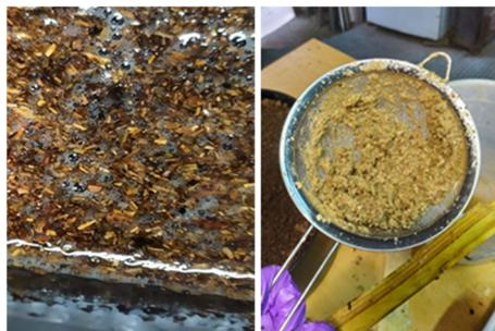
Fig. 2. Celulosa tras añadirla a la sosa caustica (izquierda) y tras el tratamiento con hipoclorito (derecha)
