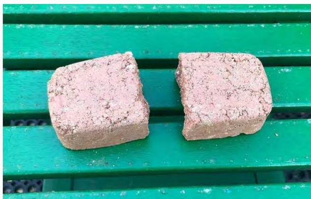
Fig.2. Probeta de arcilla y arena tras rotura.
