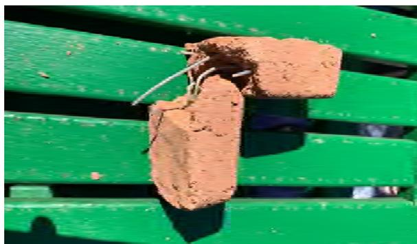
Fig.4. Probeta de arePET con ABS
