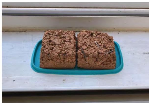
Fig.5. Probeta de arePET con ABS dispuesto en forma de fibras cortas no orientadas tras rotura.
