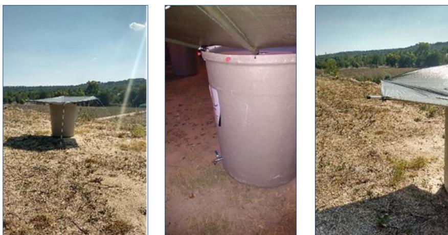
Figura 13. Sistema de captación durante el primer proceso de prueba (a), tensión en la superficie de captación debido a un incorrecto ajuste de las jaretas (b), rotura de la superficie de captación debido a la tensión de las varillas (c) .
