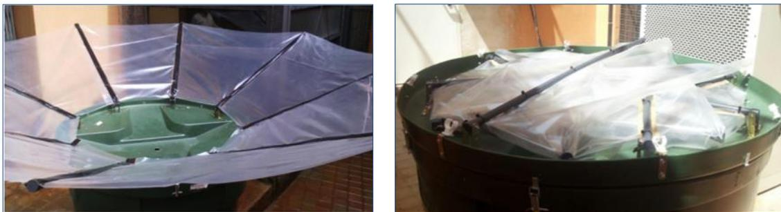
Figura 12. Desarrollo del sistema de captación de agua de lluvia: captador desplegado (a) y captador recogido (b).
