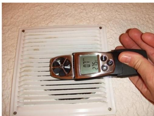
Fig.20. Detalle de anemómetro equipo usado en el interior en rejillas.
