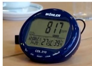
Fig.16. Equipo de monitorización del CO<sub>2</sub> CDL-210.
