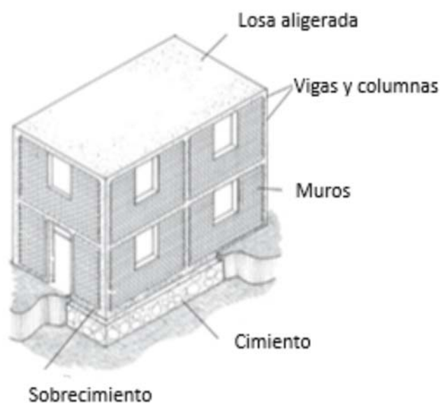
Figura 19: Vivienda Vernácula actual. Fuente: Marcial Blondet. Construcción y mantenimiento de viviendas de albañilería.
