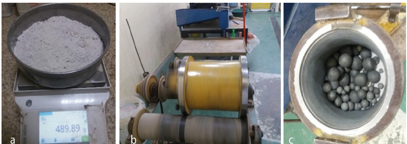
Fig. 13. Izquierda: Pesaje de material recuperado del berberecho. Centro y Derecha: Molino Giratorio.
